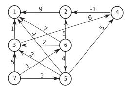
4) Si risolva il problema di flusso di costo minimo per l'istanza in figura utilizzando l'algoritmo di cancellazione dei cicli a partire dal flusso indicato, di costo cx = 71. Per ogni iterazione si mostri il ciclo individuato con il suo verso, costo e capacità, e la soluzione ottenuta dopo l'applicazione dell'operazione di composizione, con il suo costo. Al termine si dimostri che la soluzione ottenuta è ottima.
